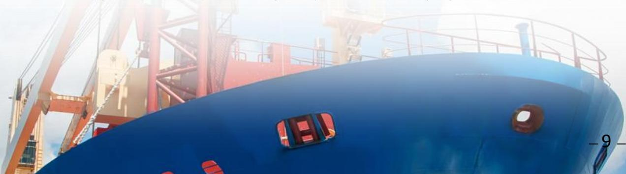
“海巡 176”轮总长 75.2 米，型宽 14 米，型深 6.3 米，设计吃水 4 米，满载排水量约为 2450 吨，续航力 5000 海里，自持力 40 天，采用全电力驱动、双全回转舵桨推进方式，配置动力定位系统，可在 6 级海况下安全航行、4 级海况下安全作业，是首艘达到 C2 排放标准的大型航标船。该轮将按计划推进设备安装调试、系泊试验、航行试验、航标作业试验等各项工作，计划 2025 年上半年交船。
