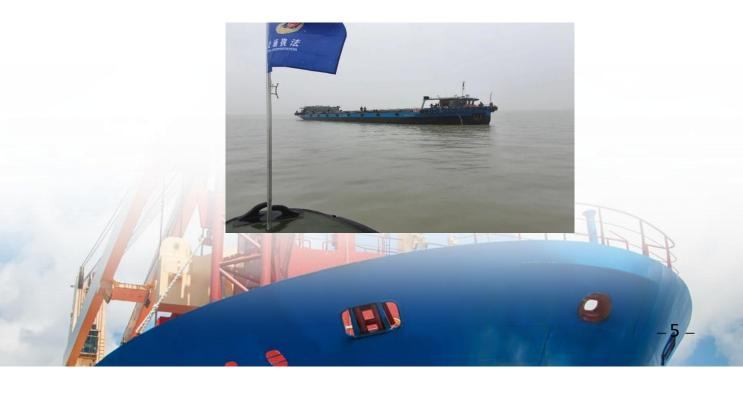
"浙港內河 002"采用电力推进系统,是满足京杭运河尺度 要求的 64TEU 标准集装箱船,配置了智能航行、智能机舱、智能 集成平台系统和远程控制系统,并针对京杭运河航运繁忙、航道 密集、桥梁分布众多的航行环境在技术性能、系统配置等方面进 行集成应用和优化,可实现远程控制和特定条件下的自主航行。
