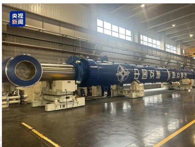
油缸是大型打桩船的核心部件。在大型桥梁、海上风电建设
