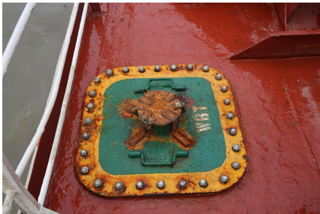
图 2：带检查孔压载水舱人孔盖（B 型）
